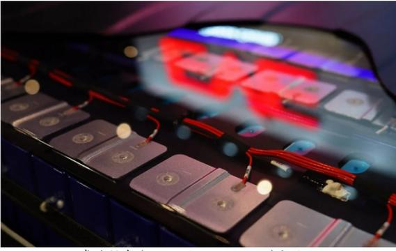
磷酸铁锂(Lithium Iron Phosphate)电池。
