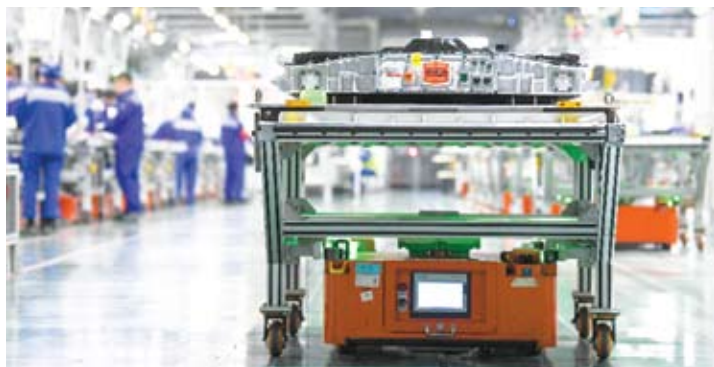
在上汽时代动力电池系统有限公司车间，一辆运输车在运送安装完成的动力电池系统件。（新华社记者 李博 摄）
