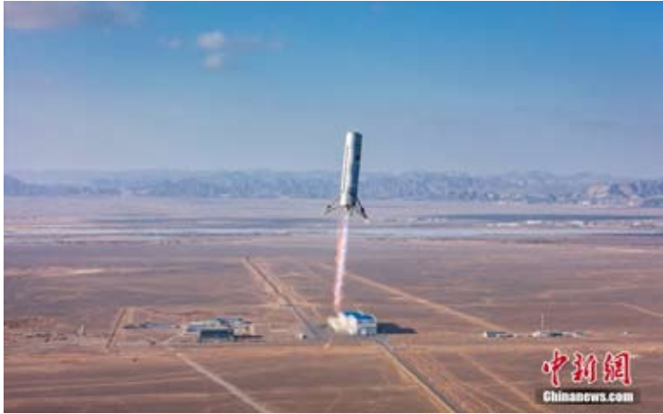
1月19日16时，蓝箭航天自主研发的可重复使用垂直起降回收验证火箭在中国酒泉卫星发射中心点火升空，验证朱雀三号大型液氧甲烷可重复使用火箭的一子级垂直返回关键技术。（无人机照片）蓝箭航天供图
