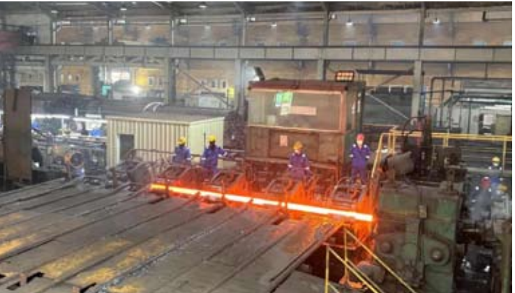
Rainbow Tubulars Manufacture (RTM) 公司正在生产无缝钢管 情景。
