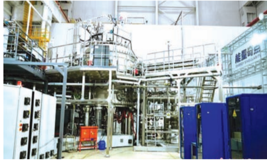
全球首台全高温超导托卡马克“洪荒70”实现了1337秒稳态长脉冲运行, 刷新商业核聚变世界纪录。狄权 摄
