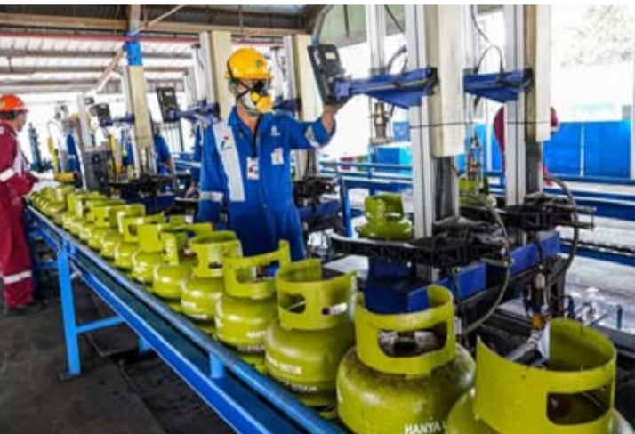
图为工作人员正在将液化石油气充入3公斤的钢罐中。
