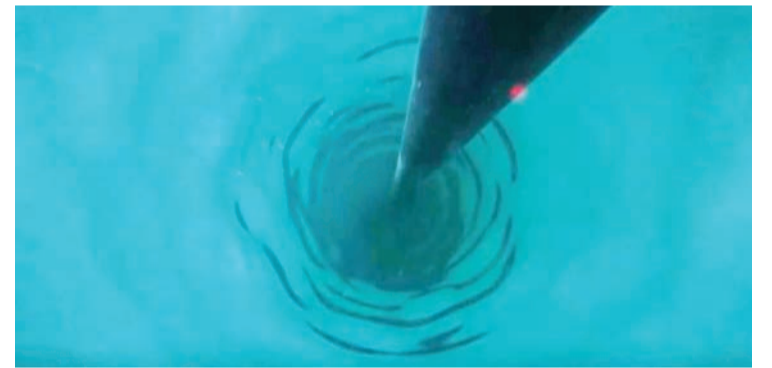
日前, 中国第42次南极考察队在东南极麒麟冰下湖区域, 成功完成中国首次南极冰层热水钻探试验, 钻深达3413米, 突破了国际极地热水钻探的2540米的最深纪录。图为中国首次南极冰层热水钻探试验孔内摄像画面。(自然资源部供图)
