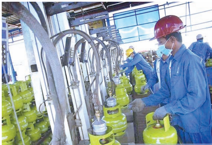
工人们在散装液化石油气加气站（SPBE）完成3公斤装液化石油气罐的充装过程。
