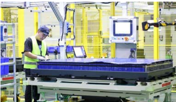
8月7日，位于山东省菏泽鲁西新区的海辰储能山东长时储能一体化产业园的首批产品量产下线。图为工人进行模组高压连接。周艺伟 摄
